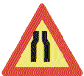
(Κ - 5) Επικίνδυνη στένωση οδοστρώματος και στις δύο πλευρές.
