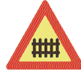
(Κ - 31) Κίνδυνος λόγω ισόπεδης σιδηροδρομικής διάβασης με κινητά φράγματα.
