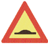
(Κ - 10) Επικίνδυνα υπερυψωμένο οδόστρωμα η απότομη κυρτή αλλαγή της κατά μήκος κλίσης της οδού.
