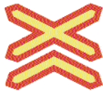
(Κ - 37) Κίνδυνος λόγω άμεσης γειτονίας, ισόπεδης σιδηροδρομικής διάβασης χωρίς κινητά φράγματα διπλής ή πολλαπλής σιδηροδρομικής γραμμής.
