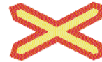
(Κ - 36) Κίνδυνος λόγω άμεσης γειτονίας ισόπεδης σιδηροδρομικής διάβασης, χωρίς κινητά φράγματα μονής σιδηροδρομικής γραμμής.
