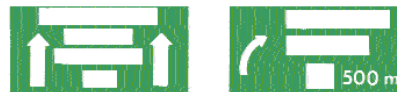
(Π - 84) Γέφυρα σήμανσης με αναγραφή κατευθύνσεων προ ανισπέδου κόμβου με αφαίρεση λωρίδας του αυτοκινητοδρόμου.
