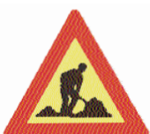
(Κ - 20) Κίνδυνος λόγω εκτελουμέ- νων εργασιών στην οδό.
